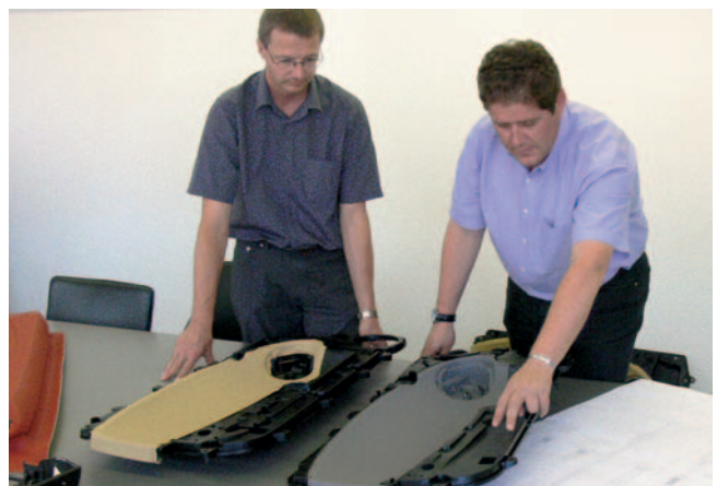
Roger Kaufmann (rechts) und Konstruktionsleiter Daniel Jenni mit der ersten und der letzten Variante des ITM für den neuen Mini aus glasfaserverstärktem PP. Deutlich erkennbar ist die neue Gestaltung im unteren Bereich, der seine Stabilität in Crashtests beweisen musste (Foto: tecpr)
