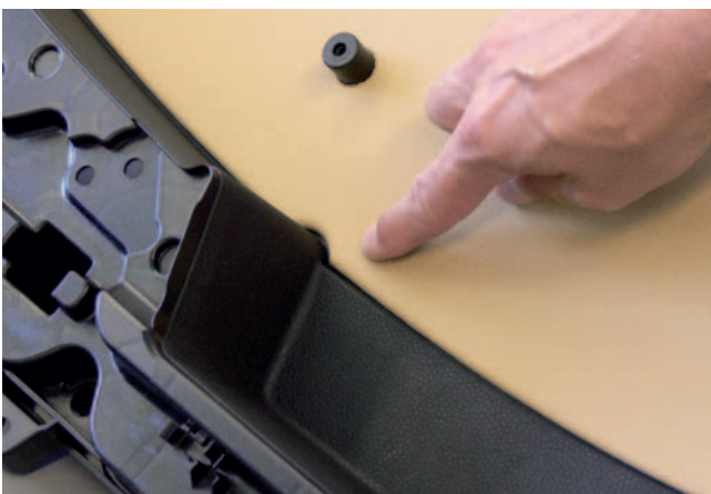
Unsichtbarer Übergang von der Innendekoration zum Sichtbereich der Kartentasche: Die Dekorkante verschwindet in einer Sicke, ein Musterbeispiel für „form follows function“ (Foto: tecpr)
