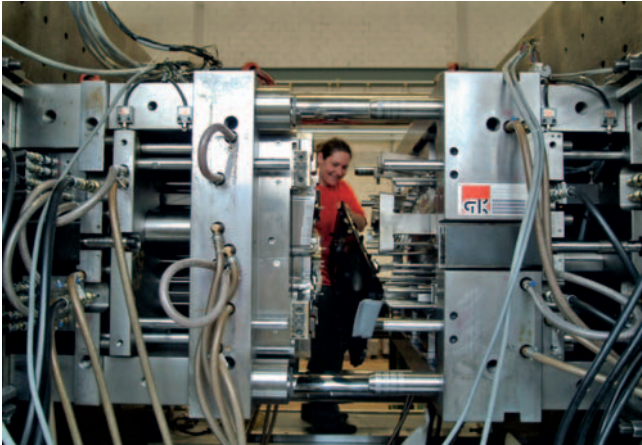
Probelauf auf der hauseigenen Spritzgießmaschine im Kaufmann-Technikum: Claudia Tschurr überprüft die Funktion der Auswerfer und Schieber, bevor neue Prototypen des ITM hergestellt werden (Foto: tecpr)
