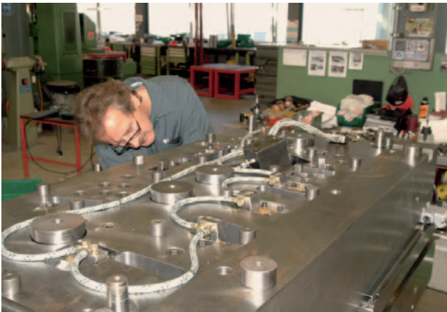
Ansicht des Werkzeugs von hinten: Gut erkennbar die Schieberkühlung. Etwa in der Mitte des Bildes erkennt man den Hydraulikzylinder für den Schrägschieber, der das TPO im Durchgangsbereich für den Resonanzraum des Mitteltöners vorstanz (Foto: Kaufmann)
